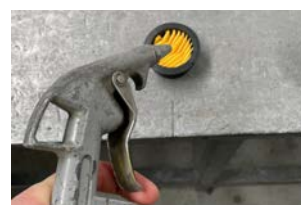
Nettoyer le filtre à l'aide d'une soufflette
